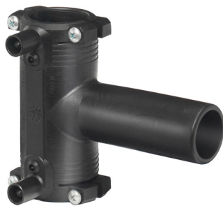
ELGEF Plus Tee 90° PE100 d20-63mm / SDR11
